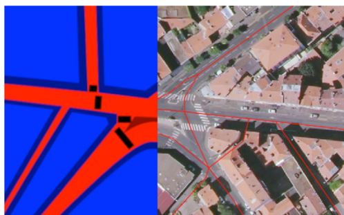
Figure 9. Juxtaposition d'une segmentation issue d'une carte collectée et d'une orthophoto augmentée de données OSM, illustrant la schématisation introduite par le tracé artisanal sur la carte collectée
