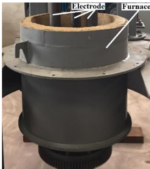
Fig. 1 The actual electric furnace
