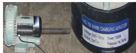
(a) Blower Fan
