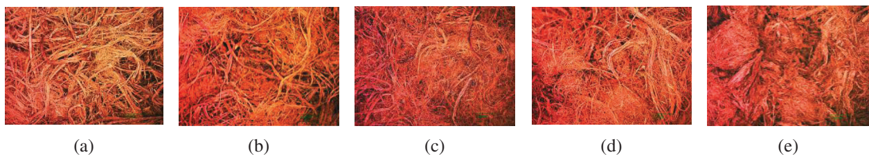
Figure 6: Bamboo fiber under steam explosion pressure 3.0 MPa. (a) 120 s, (b) 140 s, (c) 160 s, (d) 180 s, (e) 200 s
