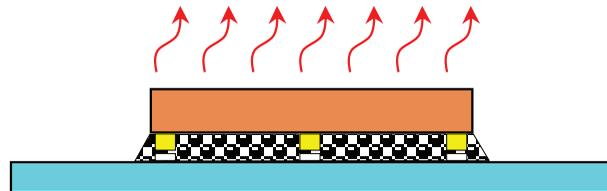
(d) Cooling of the technology to room temperature
